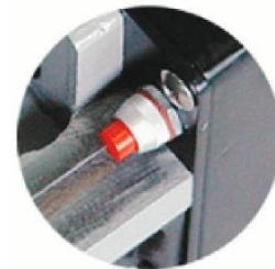
Torna işlemi bittiğinde makina sesli olarak operatörü uyarır ve makine güvenlik için otomatik olarak durur.
