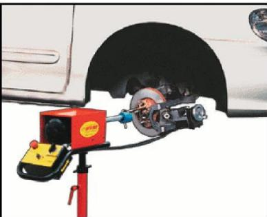
Makinayı fren diskine bağlamak için olan aparatı fren diskine yerleştirin ve daha sonra makinayı bu aparat vasıtası ile fren diskü üzerinde sabitleyin.
