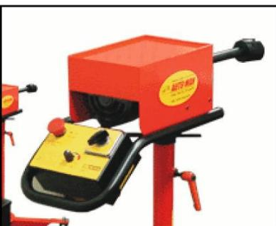
Kontrol paneli makinenin arka tarafında, en hızlı disk yüzey temizliğinin yapılacağı şekilde monte edilmiştir.
